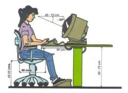
Subimos o bajamos la pantalla de forma que el borde superior de la pantalla quede ligeramente por debajo de la línea horizontal de visión del trabajador. La zona de visión confortable se sitúa de 15 a 20º debajo de esta línea horizontal de visión
